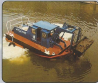
用双四斗式翻斗和长柄式挖掘杆疏浚，最深可达水下3.65米
