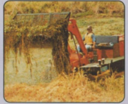
外形低矮—MARK2 的经济型设计没有驾驶室— 图为在美国佛罗里达州除水草情景
