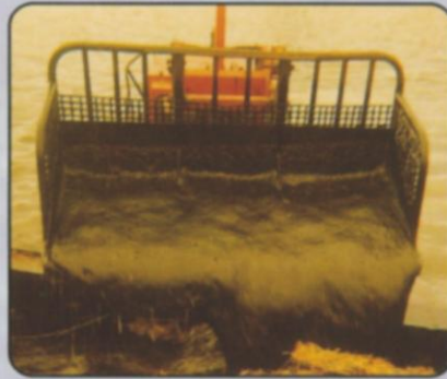
配上筛格式铲斗，水神对于清除严重的水上表面油污非常有效
