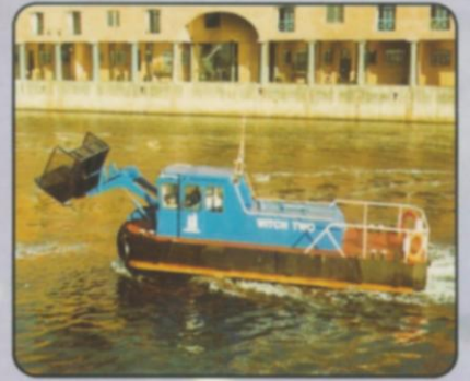
水神船只可按用户特定要求制造。图中所示为一艘除可用于疏浚和清除垃圾之外，还附有拖船功能的水神船，该船带有可拖动3吨重物体的350英制马力的拖船绳
