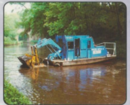
双四斗式翻斗并用大功率双液压管操作，可在疏浚之外进行从回填到平整河岸等各项工作
