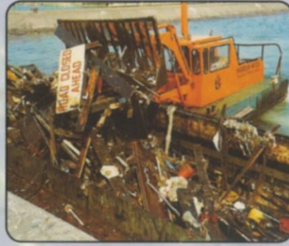
垃圾收集— 用水神的筛格式铲斗可使除杂这项艰巨的任务变得相当简单，而且只需一个操作工
