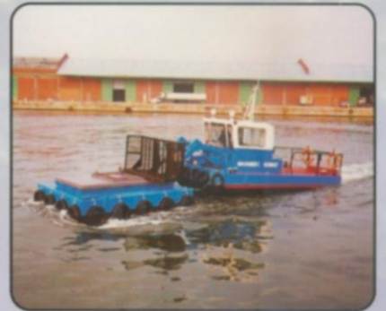
Mark3型水神在船尾设有平台，使用带翻斗平底船时，其可作为存放槽桶所用
